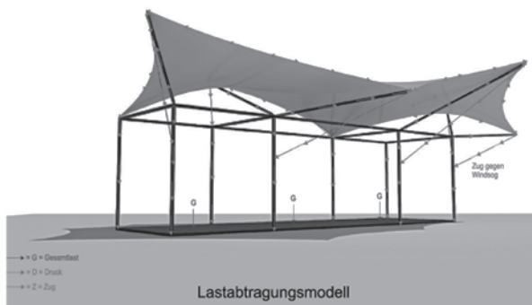
Im Modell M 1:20 wurde mittels eigenschaftsfählichem Material und unter Berücksichtigung der Kraftverläufe die Geometrie der Membran entwickelt und weiter verfeinert. Erste Probleme zwischen Entwurf und Ausführung kündigten sich an...
