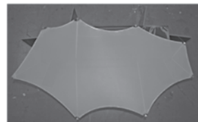
Im Modell M 1:20 wurde mittels eigenschaftsfählichem Material und unter Berücksichtigung der Kraftverläufe die Geometrie der Membran entwickelt und weiter verfeinert. Erste Probleme zwischen Entwurf und Ausführung kündigten sich an...
