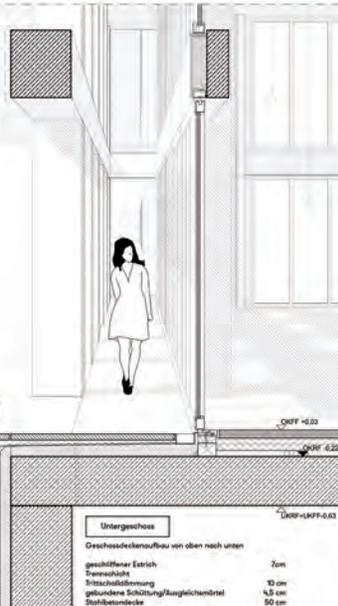
Geschossdeckenaufbau von oben nach unten
